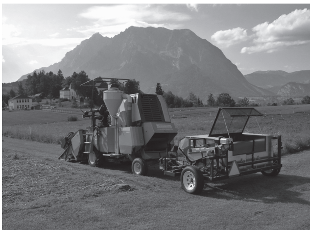
Obr. 2. Kombajn s kartáčovým zberačom na zber zreých semien autochtónnych druhov v množiteľskej škôlke Raumberg-Gumpenstein v Rakúsku (2011). Foto: Ján Novák
