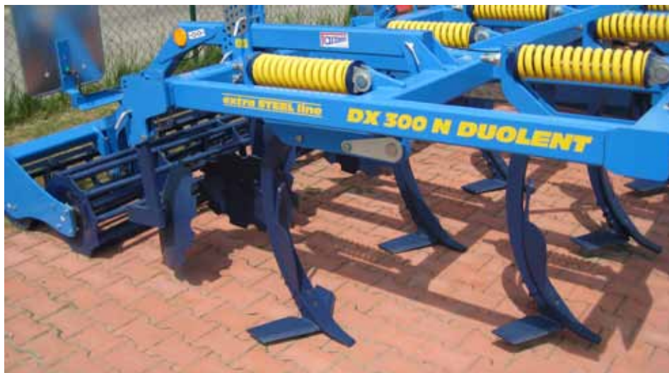
Obr. 1. Jeden z typov náradia používaného pri pôdochrannom obrábaní pôdy. Šípovité radlice pôdu nakypria, ale neobrábia, šikmo sklonené vykrajované taniere upravia jej povrch a prúťové valce vzadu rozdrobia hrudy. (Pospišil, 2018)
