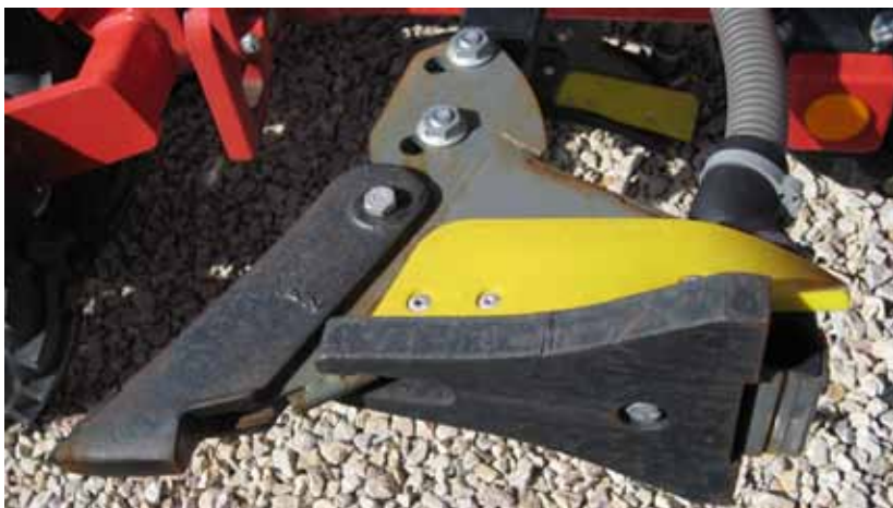
Obr. 2. Radlička pre pásový výsev a hnojenie do riadku Duet (pohľad zblízka): v spodnej časti sa za hrotom do riadku (pásiku) aplikuje tekuté hnojivo, hrubá platnička pôdu pritlačí a cez hrubú hadicu v hornej časti sa na vrstvu pôdy ukladá do pásu osivo, zasiatý pásik sa zahrnie pôdou a pritlačí gumovými valcami, (Pospíšil, 2018)
